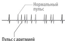
Если во время измерения обнаружен нерегулярный ритм пульса, то по окончании измерения на дисплее появится значок аритмии. При этом измерение будет произведено.
